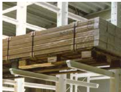
Kragarmregal für Materialpakete Ideal zur Lagerung von Paketwaren mit variierenden Abmessungen.
